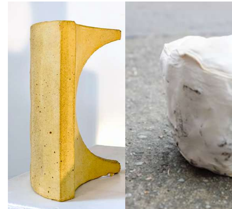
Mitkunstzentrale, Geopolymerbeton-Steine und Mycel-Verbundstoff
